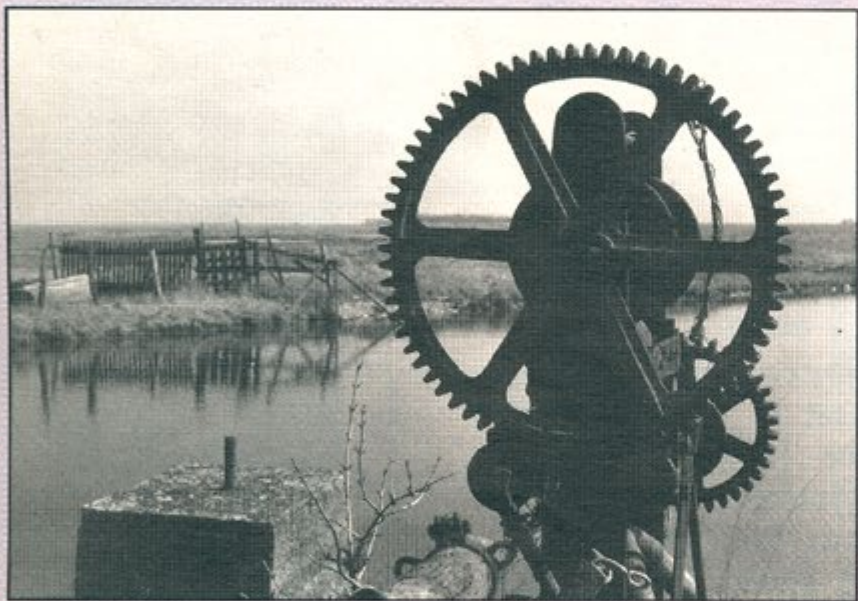
Udsigt over den vandfyldte kalkgrav. Maskindelene i forgrunden er de sidste rester af den kraftige pumpestation, der skulle holde trit med de indtrængende vandmasser.
