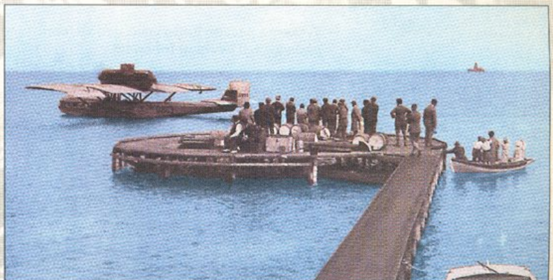
Farman Jabiru foran administrationsbygningen i 1926. Flyet kunne tage 8 passagerer, der sad i kurvestole foran i kabinen. Ovenpå, i fri luft, sad piloten. Flyet klarede en topfart på 175 km/t med sine 4 stks. 180 HK motorer.
